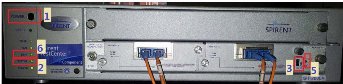
按上图所示步骤，先将机箱“Power”按钮按下（机箱前面板左侧“Status”灯起初为红色），等待 3~10 分钟（在此过程中，机箱前面板左侧“Status”灯会依次变为橙色、浅橙色、浅绿）后，机箱启动完成（机箱前面板左侧“Status”变为纯绿色）。
