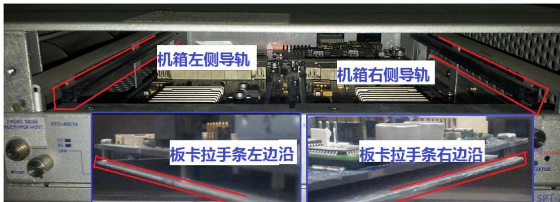
上图中共 4 个红色线框，上边两个红色线条框住的是机箱的左右两侧导轨，下边两条红色线条框住的是板卡拉手条（用于承载板卡 PCB 的金属板）左右两边的边沿。
