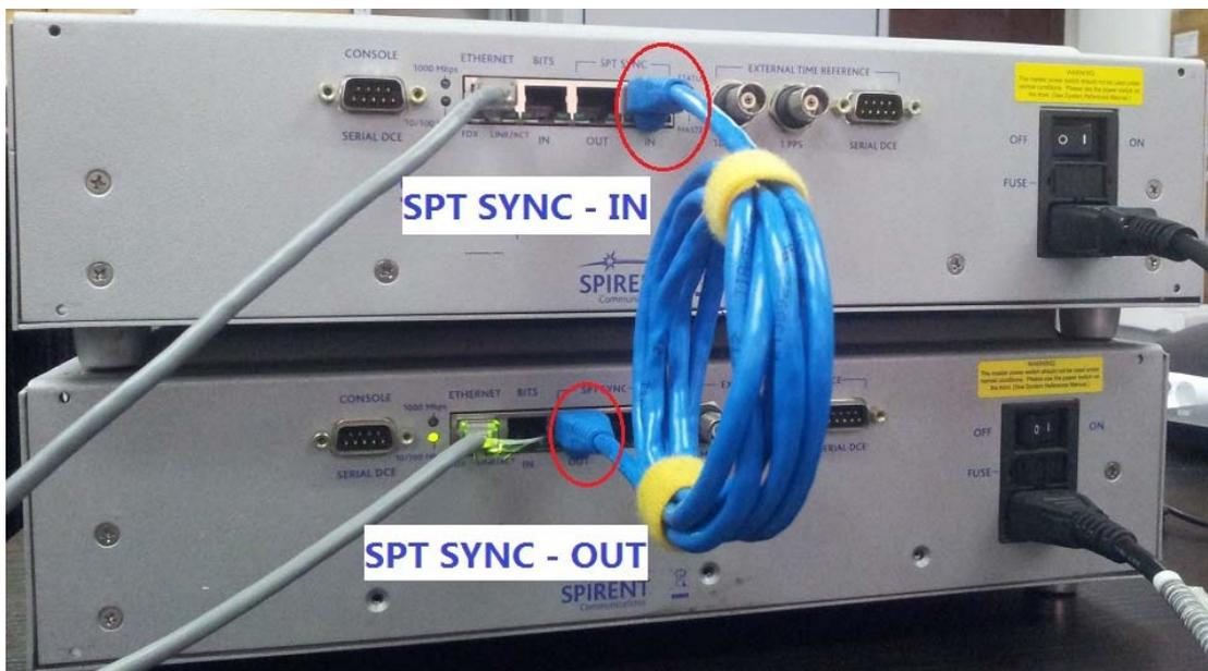
下面一台为主（Master），上面一台为从（Slave），同步信号由主机输出，输入到从机，从而两台机器共用主机的时钟源头。时钟同步网线可达 30 米，这种方式是几种时钟同步方式中，误差最小的：
