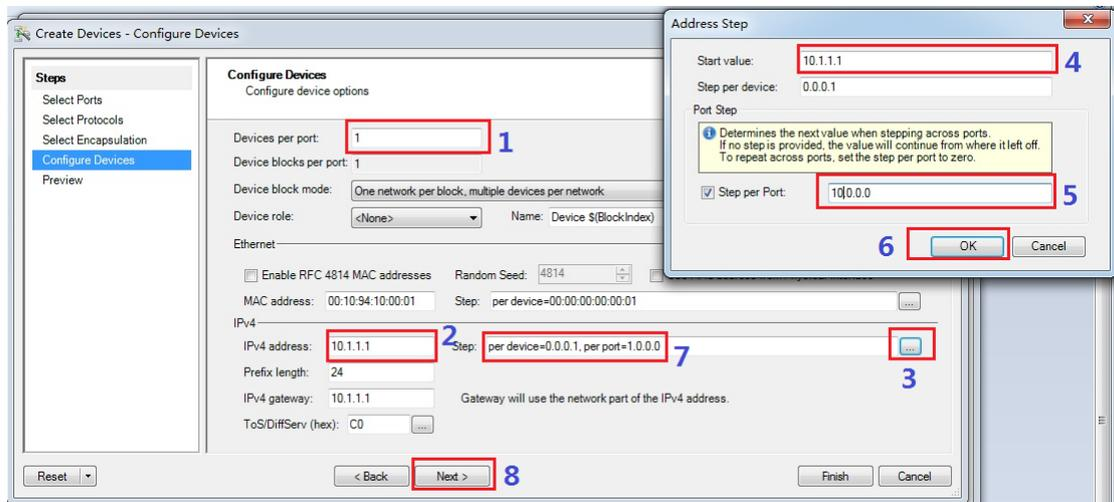
为简单器件，本例中每个端口只分配了一台主机（即“Device”），如需多台主机，修改上图中“1”标示的位置即可。
