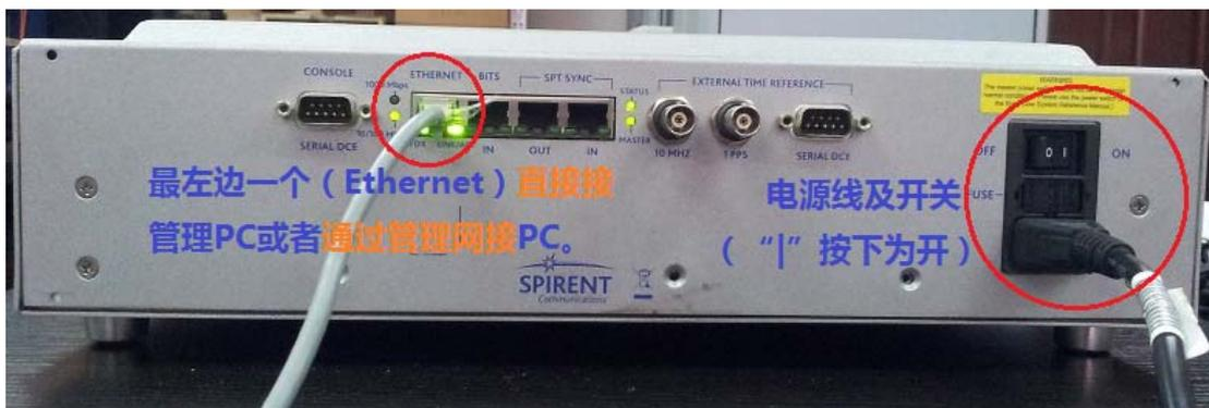
“Ethernet”口为管理口，使用网线直接连接到管理 PC（任意一台装有“TestCenter Application”应用程序的 PC）或者通过管理网络（例如您办公室的局域网）连接 PC。
